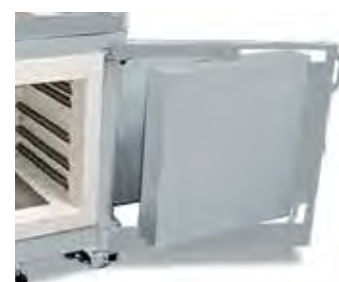
Porte pivotante parallèle pour ouverture à l'état chaud
