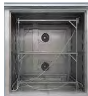
Cadre de cartographie adapté pour four chambre à circulation d'air N 7920/45 HAS
