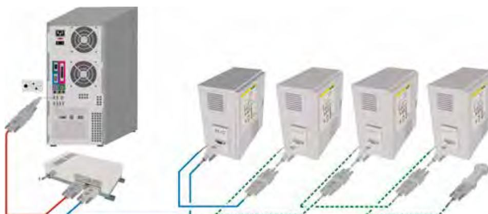
Extension pour raccordement de 16 fours maximum
